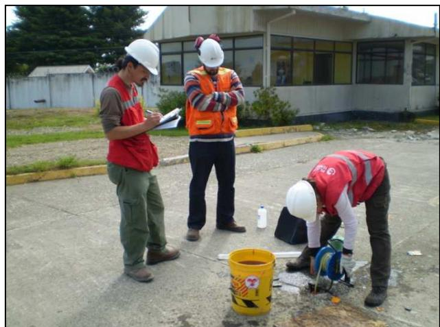
Extracción de Muestras de Suelo y Agua Subterránea para Análisis In-Situ y despacho a Laboratorio
