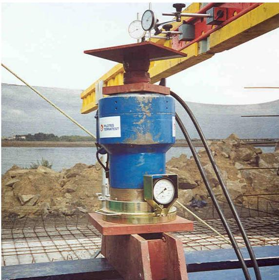
Foto 1: Detalle de ubicación de diales comparadores y celda de carga en gato hidráulico modelo VSL ZPE 5-12
