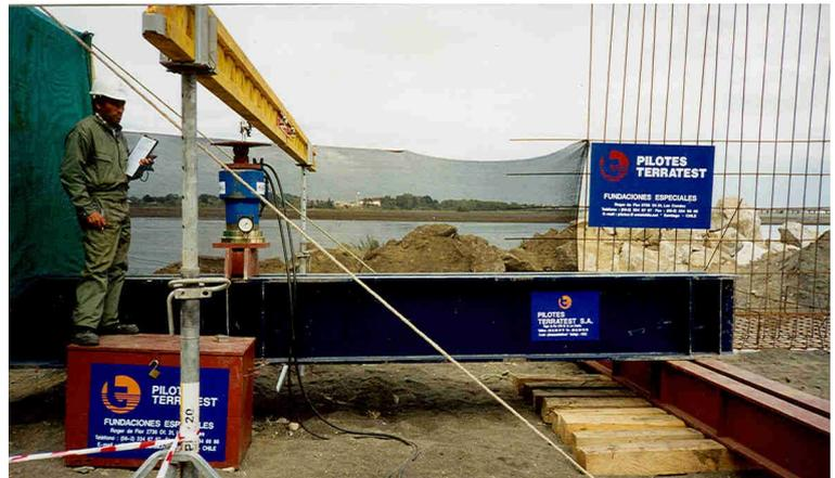
Foto 2: Estructura de Ensayo de carga a tracción.
