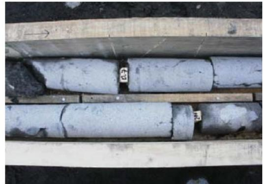
Imagen 3 - Extracción de Testigos de las Columnas para valorización de la resistencia.
