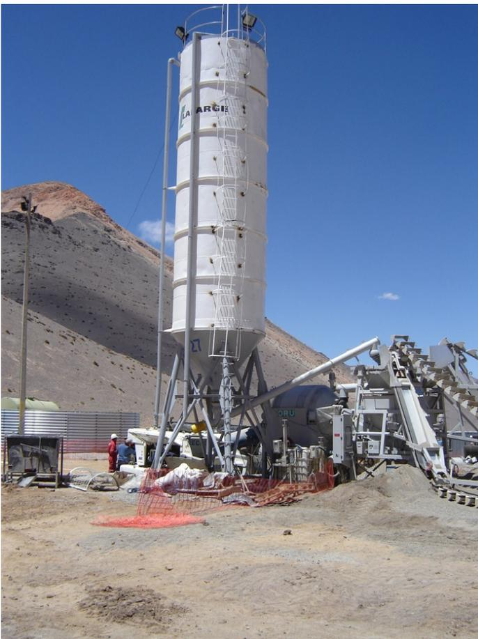
Planta de Hormigón con capacidad de 35 m<sup>3</sup>/hr. Para el agua de amasado del hormigón plástico, se utilizó agua industrial de mejor calidad y pH 7-8.
