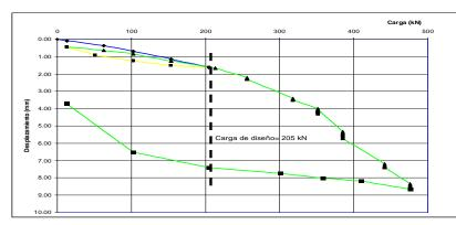
Figura 2: Ensayo de aptitud pilote φ 600 mm.
