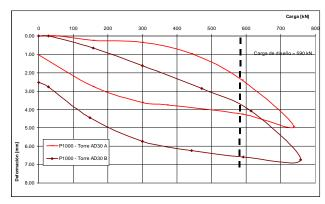
Figura 3: Ensayos de control y aceptación pilote φ 1000 mm.
