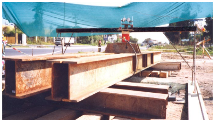
Foto 2 – Ensayo de carga Pasarela La Serena.
