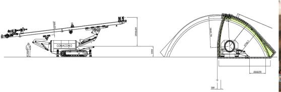
Figura 1 – Vista Lateral del Equipo y Posicionamiento en el Sidedrift
