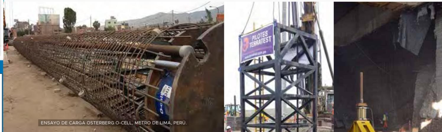
ENSAYO DE CARGA OSTERBERG O-CELL, METRO DE LIMA, PERÚ.
