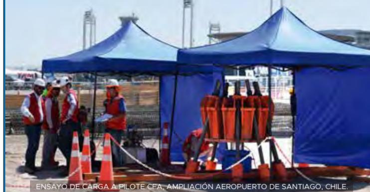
ENSAYO DE CARGA A PILETE CFA, AMPLIACIÓN AEROPUERTO DE SANTIAGO, CHILE.
