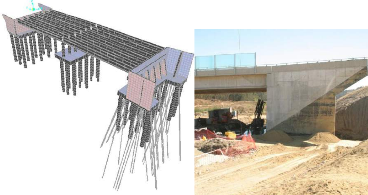
FIGURA 2 Refuerzo del estribo con micropilotes Ischebeck Titan 103/78.
